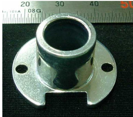
φ14.4×h16 フランジφ27 材質:SPCE 寸法公差:外径φ14.4±0.05 内径φ10.5+0.05/-0
