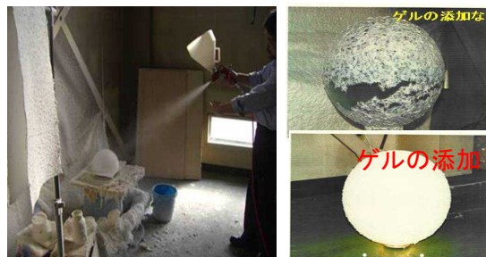
写真2 ゲルが和紙の吹付コーティングを可能にした、ランプシェードの製作
