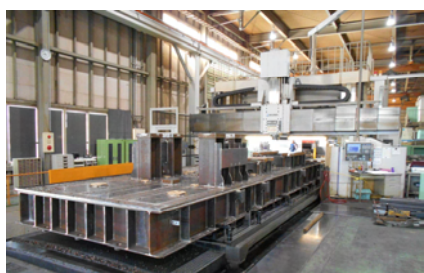
コンプレッサー用架台
