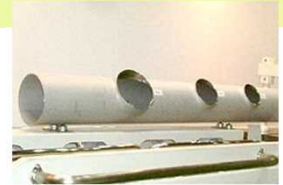
配管バーリング
