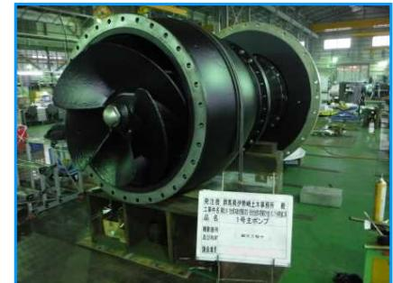
分解整備にて、塗装を施すことによって、腐食の進行を抑制。
