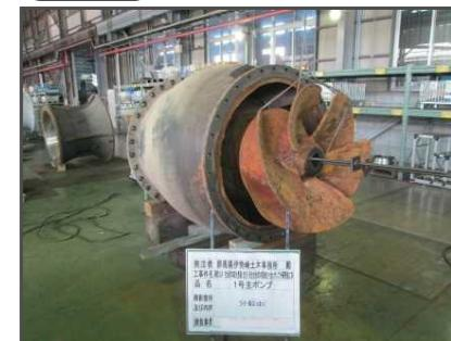
ポンプの吐出量低下を引き起こす羽根車の腐食が確認された。
