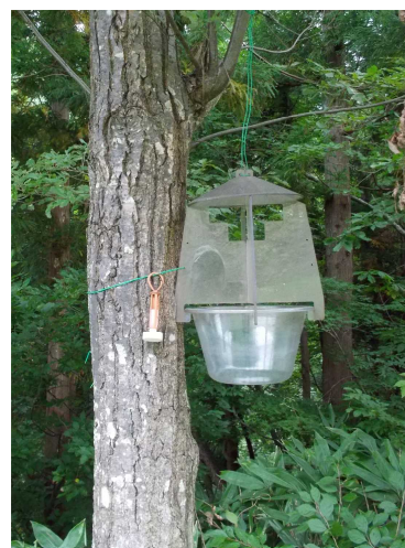
図-3 衝突板トラップ設置状況
