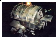
空冷式みぞ形電気炉
