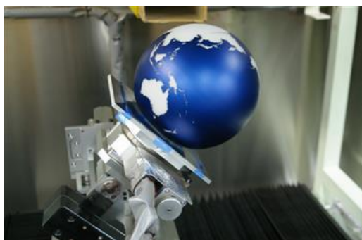
自社開発 5軸制御 3次元レーザーマーキング機
