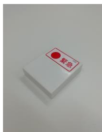
ウェアラブルセンサー サイズ: 44 × 38.5 × 11 (mm) 質量: 24g
