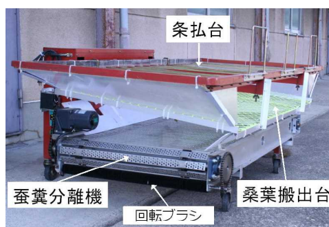
図 熟蚕収集条払機とその構成
