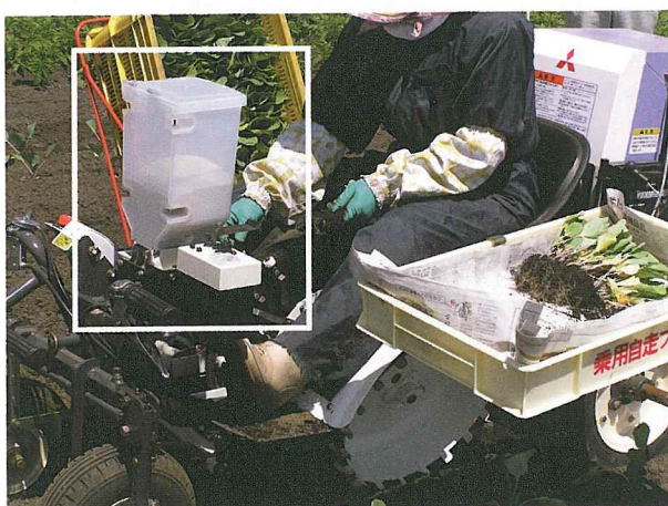
写真2 薬剤ホッパーとコントローラー（白枠内）
