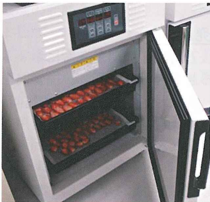
写真1 電気式乾燥機
