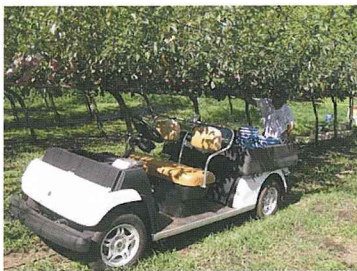
写真1 自動走行車を使用した収穫作業
