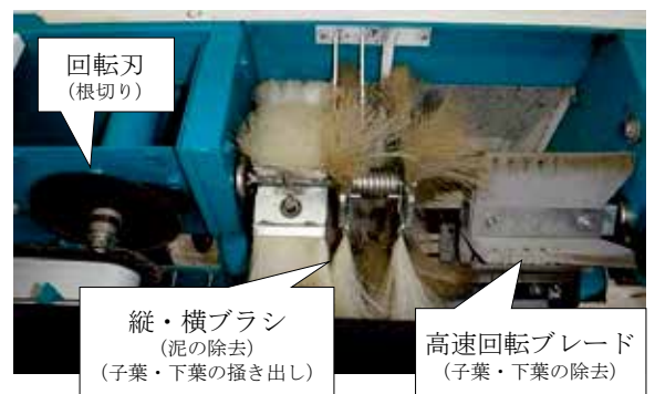
図2 試作機調製部の内部構造
