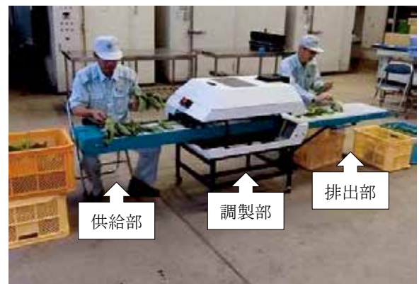
図1 試作機の構造と調製作業
