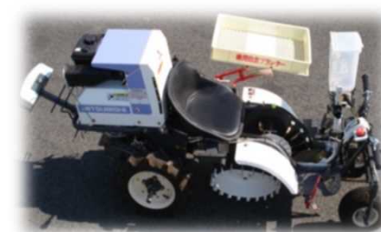
移植同時粒剤植穴施用装置 (群馬県開発)
