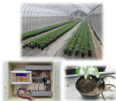
自動かん水装置(群馬県開発 トマト、キャベツ) 日射比例自動かん水装置
