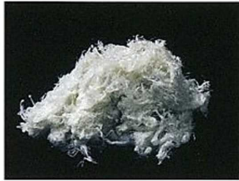
白石綿(クリソタイル)
