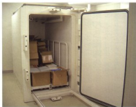
① 燻蒸室で段ボール箱に入った文書を殺虫・殺菌します。
