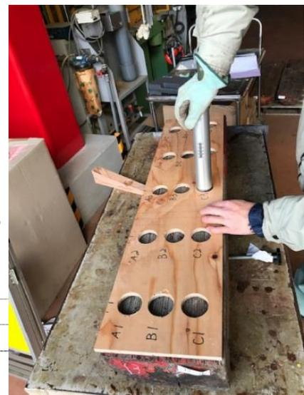
図-6 打込貫入試験の様子 (ピロディン打込)
