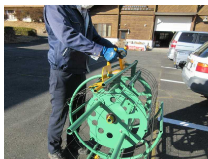
③付属の押込ハンドルでワイヤーメッシュの端同士を重ねる
