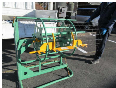
⑥加工機の横から引っ張り出して単木柵完成
