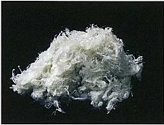
白石綿(クリソタイル)
