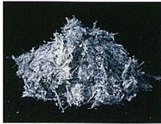
青石綿(クロシドライト)
