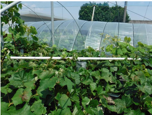
図2 接触棒が回転動作する新梢管理装置
