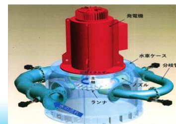
水車発電機のしくみ
