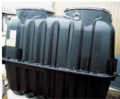
合併処理浄化槽
