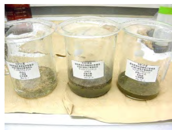
図 2-16 過酸化水素水による前処理
