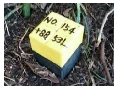
幅杭（黄色い杭）
