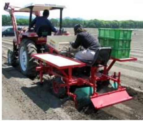
こんにゃく「みやままさり」に対応した球状生子植付機（平成25年）
