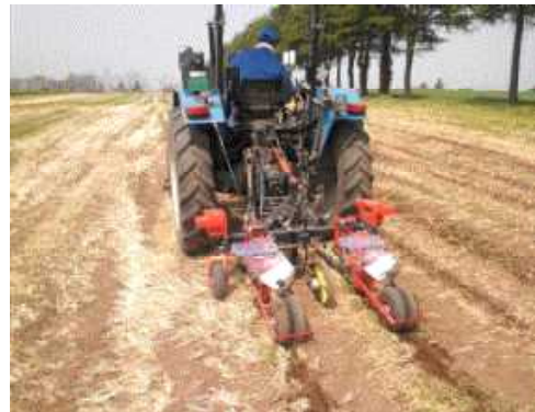
トウモロコシ不耕起播種機を利用した飼料作物の低コスト化（平成 24 年）
