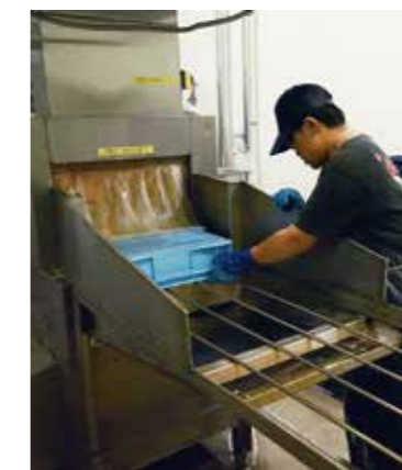
■コンテナ洗浄 工場内で食品などを入れるコンテナを、専用の機械を使用して洗浄します。
