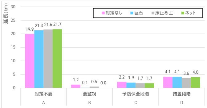
護岸基礎高：現在（H29年2月）の平均河床高より-1mの高さと想定
