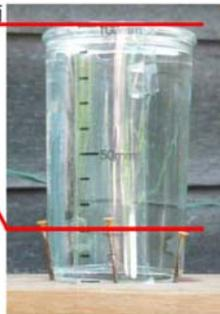
カップ酒のビン以外にも、寸胴で、風で倒れないような重さのある入れ物であれば、誰でも簡単に雨量計測が可能
