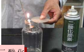
集気瓶に二酸化炭素を注入する
