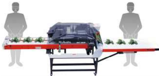
初心者でも熟練者並みの能率で作業ができる新型軟弱野菜調製機（平成30年）
