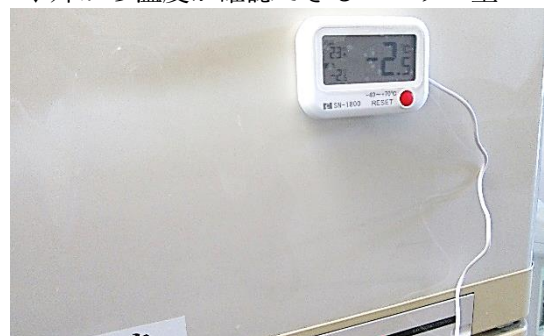
↓外から温度が確認できるセンサー型
