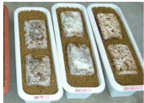
図-6 プランター伏せ込み状況
