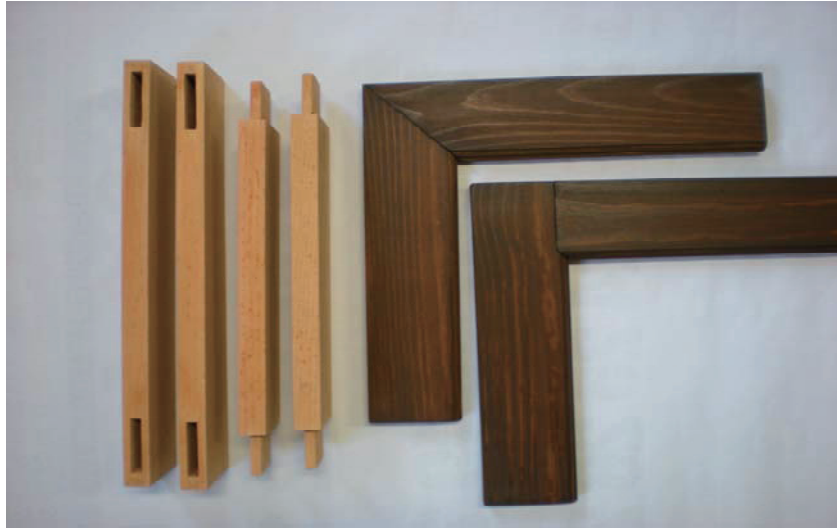
図－7 アカマツ処理材の仕口加工
