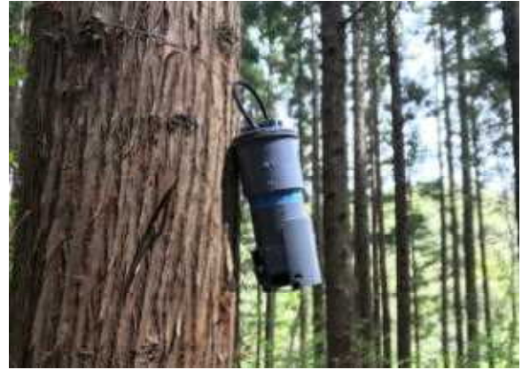
設置した捕獲通報装置
