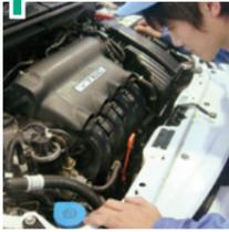
音や振動など人間の五感と、故障診断器などの先端機器を駆使してエンジンを点検・整備します。
