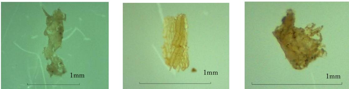
採取されたマイクロプラスチック (左・中:ポリエチレン、右:ポリプロピレン)
