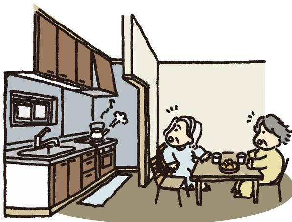
住宅の場合、火を使うキッチンや暖炉のあるリビングなどは、壁材を防火材料にしなければなりません。建築基準法で内装制限という規制です。ダイニングキッチンなどの大部屋では防火上、たれ壁が必要な場合もありますので、必ず、建築士と相談してください。
