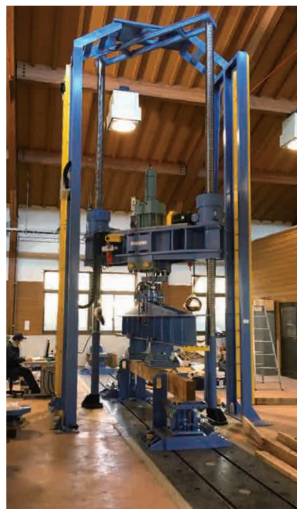
図-1 1000kN実大強度試験機
