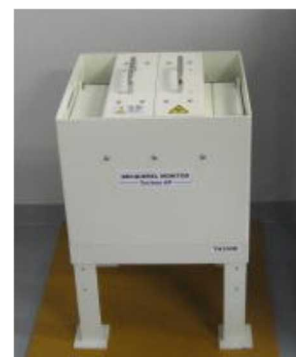
西部教育事務所に 設置されている NaI シンチレーション検出器
