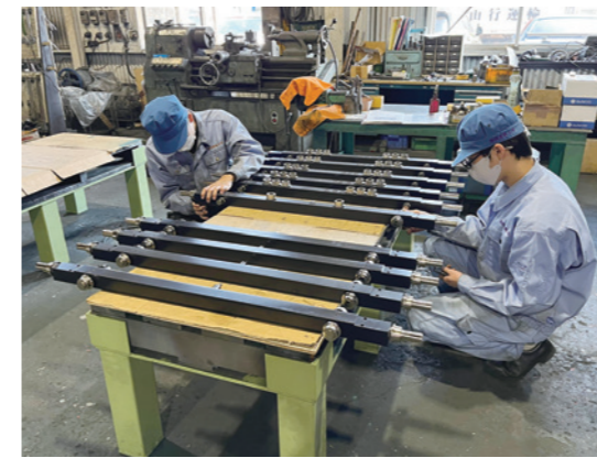
免震装置の部品を確認する従業員
