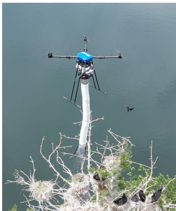
図9 ドローンによるコロニーの巣へのドライアイス投入
