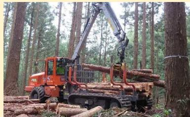
この低コスト作業システムは、ロングリーチハーベスタと走行性に優れたフォワーダ (F801) による 2 人体制の作業システム。作業道を高密度 (緩傾斜地では 250m/ha 程度) に作設し、ロングリーチハーベスタの直伐り・直取りでの作業範囲を確保し、人力での作業を抑える工夫をしている。
