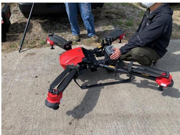
写真8 「XAG-P30」の機体（タンク装着前）
