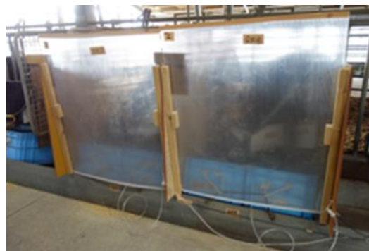
ドアフィーダを用いた黒毛和種肥育牛の個別呼気ガス測定
