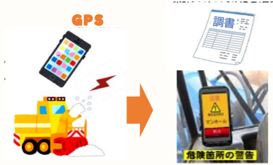
除雪車にGPS 端末を搭載 稼働状況を自 動送信
