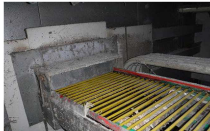
集卵バーコンベアが鶏舎外に出る部分は、集卵作業時以外は閉鎖する
