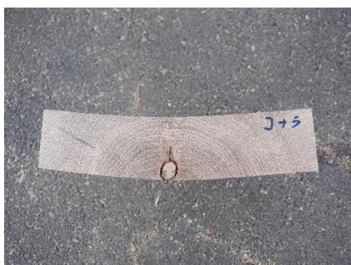
図－１ コナラ乾燥後断面図
