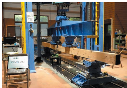
図 大断面長尺材強度試験
