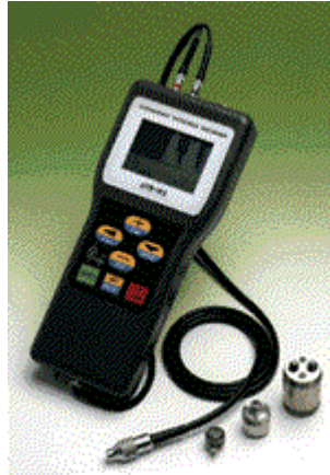
図－１ 超音波厚さ計の一例
